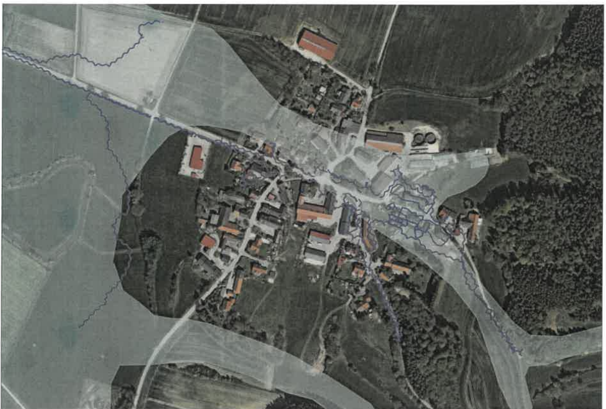
Wassersensible Bereiche mit Darstellung des angrenzenden HQ 100 an der Zusam und der Neuberechnung (Sweco GmbH 2022) entlang des von Osten kommenden Grabens
